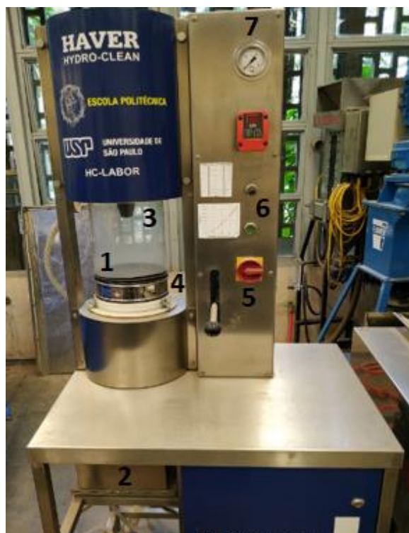
Figura 13 – Vista geral do equipamento HC 200-LAB da Haver: 1-câmara de lavagem, 2-coletor ( underflow ), 3-bico de alta pressão, 4-peneira, 5-botão de ligar/desligar, 6-timer, 7-medidor de pressão
